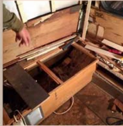
Met smalle strookjes triplex en sneldrogende lijm wordt het spant opnieuw opgebouwd.
