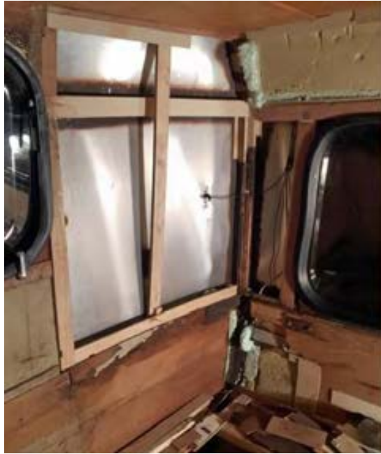
Met smalle strookjes triplex en sneldrogende lijm wordt het spant opnieuw opgebouwd.
