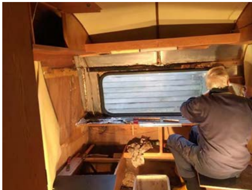
De omlijsting van het raam achter moet helemaal opnieuw van hout worden voorzien.
