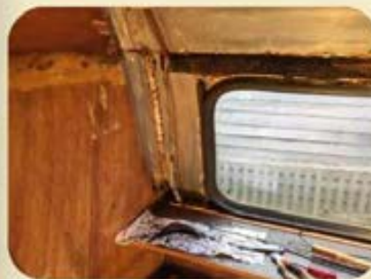
De omlijsting van het raam achter moet helemaal opnieuw van hout worden voorzien.
