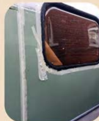
De onderkant moet in vorm worden gebracht d.m.v. autokrikken.
