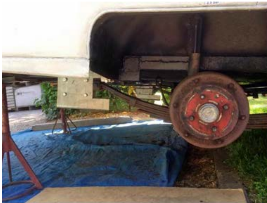
De 520 wordt klaargezet om de gaten in het chassis dicht te lassen.
