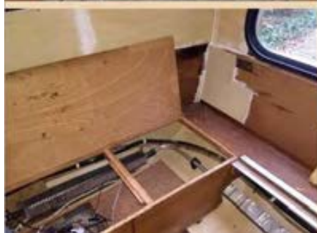
De wanden zijn terug geplaatst en gladgemaakt met plamuur.
