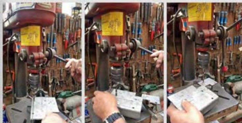
Het boren van de gaten voor de bouten.
