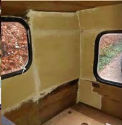
De wanden zijn terug geplaatst en gladgemaakt met plamuur.
