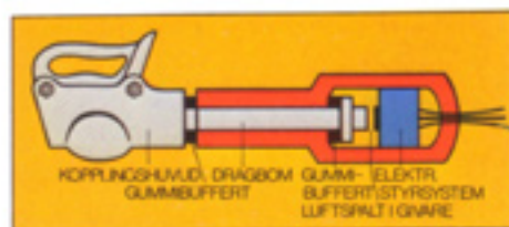
Lastkännande bromsar är standard på alla SMV.
