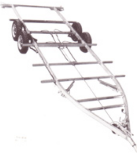
Det unika lätta chassiet i SMV 590-fyrkantprofil i aluminium.
